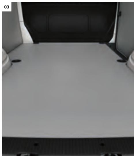
**03 Plancher universel (pour transformations).** C'est l'idéal pour permettre la pose ultérieure de systèmes de rangement conçus spécifiquement par différents fabricants<sup>2)</sup>. Des adaptateurs spéciaux<sup>3)</sup> dans les découpes du revêtement permettent la pose et le démontage, à tout moment, des systèmes de rangement, sans collage ni perçage. Le retrait du plancher ne laisse que des résidus minimes. | VA |
