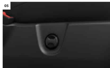
**05 Soutien lombaire à réglage électrique.** Il offre un confort d'assise précis, avec un réglage progressif dans quatre positions. | VA | CO | PC | PL |
