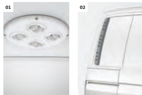
**01 Aérateurs de toit.** Les ouvertures au niveau du toit permettent d'aérer ou de ventiler les espaces dédiés aux passagers et au chargement. |VA|CO|PC|
