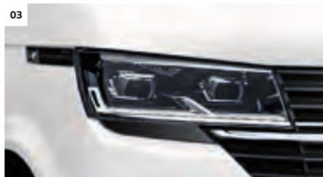
**03 Projecteurs LED.** La technologie LED pour les feux de route et de croisement donne au véhicule une signature lumineuse distinctive et une forte intensité d'éclairage. | VA | CO | PC | PL |
