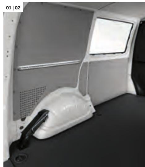
**01 Habillage (sur toute la hauteur) des parois latérales en panneaux de fibres dures.**<sup>1)</sup> Des panneaux de fibres dures peuvent être montés sur toute la hauteur jusqu'au toit des parois du compartiment de chargement. | VA | CO | PC |
