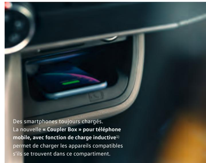
Des smartphones toujours chargés. La nouvelle « Coupler Box » pour téléphone mobile, avec fonction de charge inductive<sup>2)</sup> permet de charger les appareils compatibles s'ils se trouvent dans ce compartiment.
