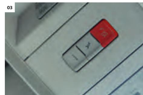
**03 eCall.** Après un accident, il transmet automatiquement à la centrale d'appels d'urgence l'heure, la position et le nombre d'occupants dans le véhicule, puis établit une liaison vocale. Le système est activé par un capteur détectant le choc ou manuellement par la touche d'appel d'urgence. |VA|CO|PC|PL|
