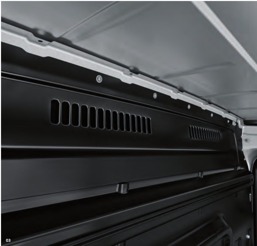
03 Climatisation à réglage électronique avec deuxième extracteur. Pour le transport professionnel de personnes ou de marchandises sensibles à la température, le Crafter peut également être équipé d'une climatisation pour l'espace de chargement. Le deuxième extracteur est installé dans le ciel de toit de la cabine conducteur et les diffuseurs sont situés en haut de la cloison de séparation. | VA | PC |
