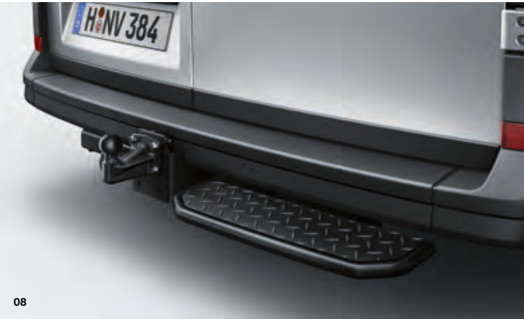
07 Marchepied intégré dans le pare-chocs arrière. Il s'étend sur toute la largeur du véhicule et facilite le chargement et le déchargement. | VA | PC |
