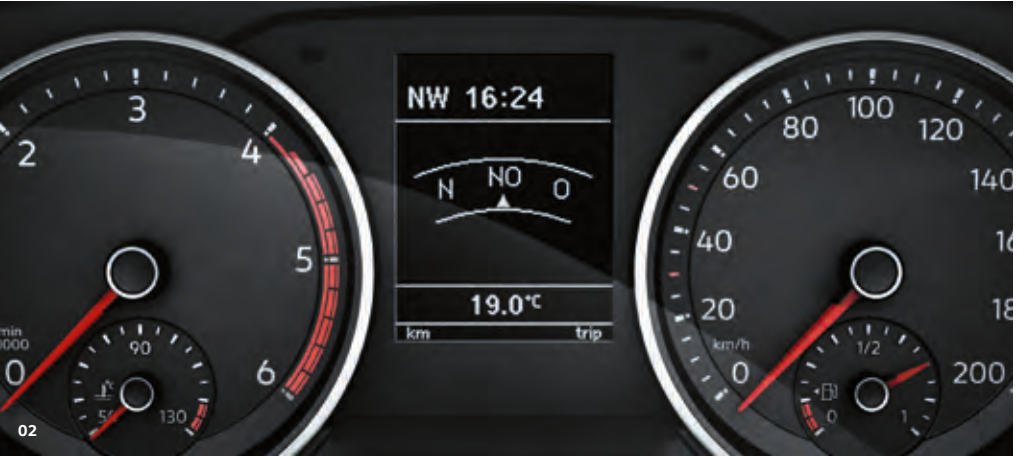
02 Affichage multifonction Plus. L'écran TFT monochrome affiche les données en temps réel, comme la température extérieure, l'autonomie du véhicule, la vitesse et la consommation moyenne. Il permet en outre de gérer confortablement les systèmes d'aide à la conduite et de procéder à un rapide contrôle des fonctions du véhicule. | VA | PC | PL | BE | CG | CH |
