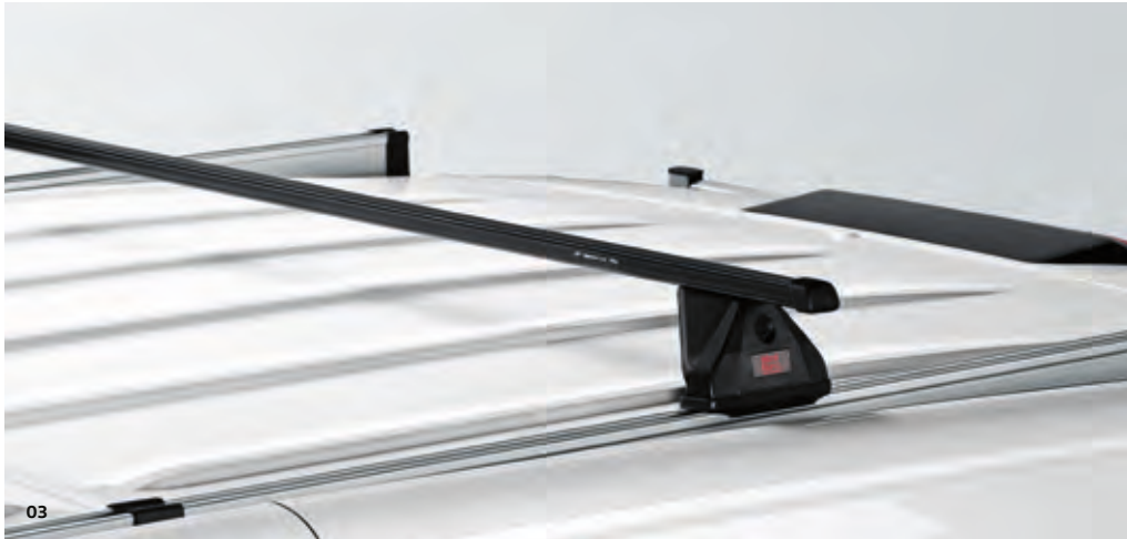
03 Barres de toit. Les barres en aluminium et acier galvanisé sont fixées sur les rails en C. Elles ne sont disponibles qu’avec le toit bas (H2) et offrent une capacité de charge de 150 kg. | VA | PC |
