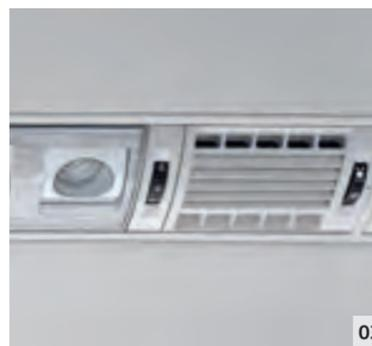
**03 Ciel de pavillon Confort.** Les diffuseurs d'air du ciel de pavillon assurent une entrée d'air frais dans le compartiment passagers et réduisent l'embuage des vitres latérales. Les liseuses intégrées orientables peuvent être réglées individuellement.
