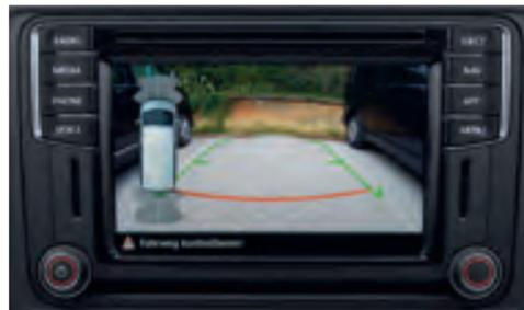
**Caméra de recul « Rear View ».** La caméra de recul « Rear View » facilite les manœuvres de stationnement en représentant la zone située à l'arrière du véhicule sur l'écran de la radio<sup>2)</sup> ou du système de navigation. Des lignes de guidage fixes montrent comment s'orienter lors de la manœuvre. | CL | CA |
